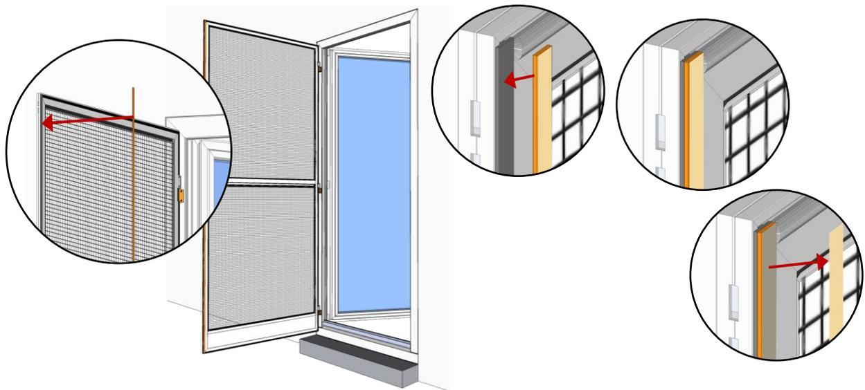
Nach Abziehen der Schutzfolie drücken Sie den Insektenschutztürrahmen ,mit der Klebeseite zum Türstock, fest an den Türrahmen auf.
