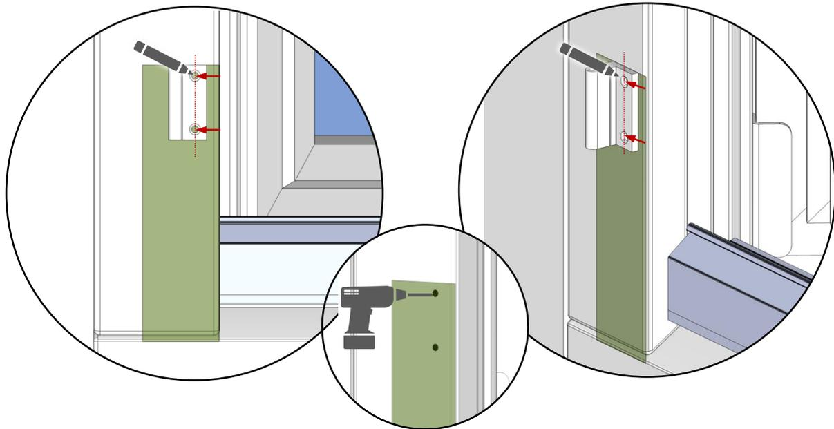
**Halten Sie nun das Scharnier auf dem Türrahmen an der gekennzeichneten Stelle an, markieren Sie die Bohrlöcher und bohren vor.**
