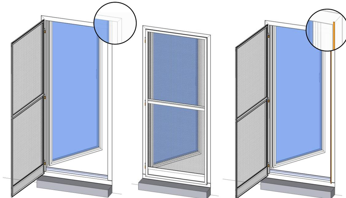
Achten Sie darauf, dass eine optimale Anhaftung zwischen der Klebfläche des Magnetbandes und dem Türrahmen hergestellt ist.
